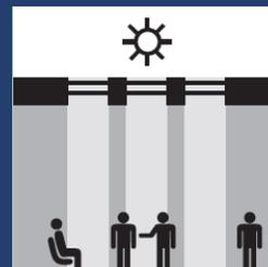
Con las láminas LUXON / Acrylit la luz se difunde dentro del edificio a diferencia de los translúcidos regulares que sólo transmite sin propagar la iluminación.
